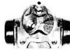
2. RBZ 178 rechts/right System: Bendix Ø 17,46 mm > 1986 - 4x4
