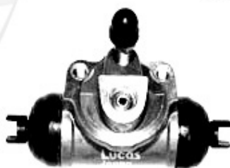
3. RBZ 398 links/left System: Bendix Ø 17,46 mm 1987>
